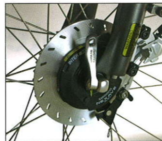
Erstklassige Verzögerung, nahezu wartungsfrei: Shimano Rollenbremse
